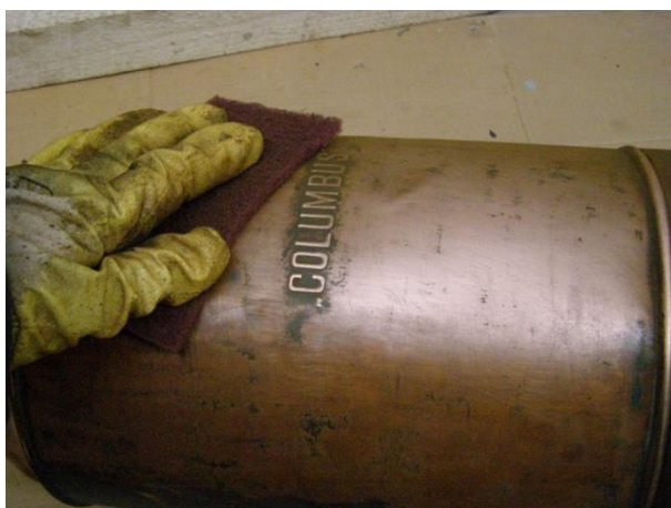
Réztartály tisztítása dörzspárnával.
