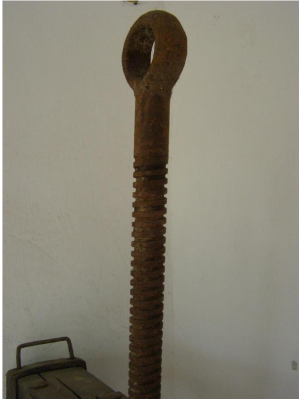
A korrodált nyomóorsó.
