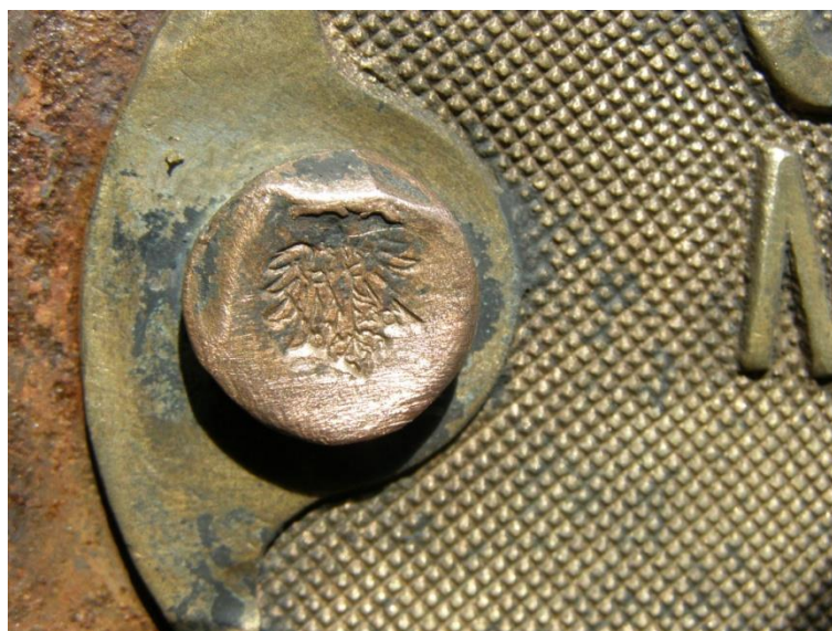
A géptábla megtisztított eredeti szegecsfeje.
