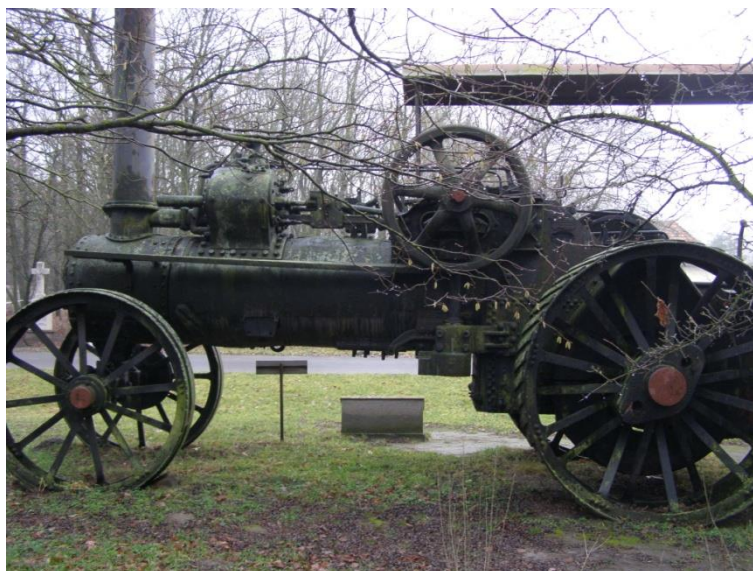
A víztér alól hiányzó sodronykötéldob helye.
