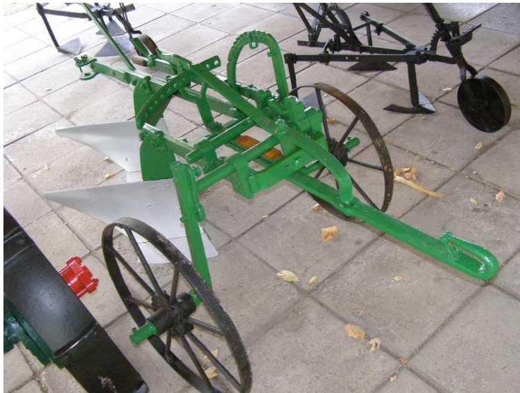
Kétvasú vontatott SACK eke.
