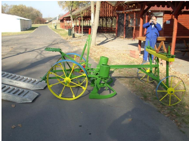
Kétsoros amerikai kukoricavető-gép.
